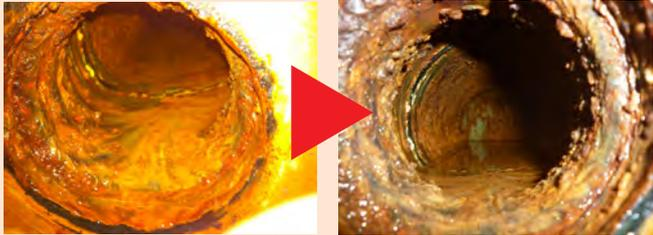
写真は赤錆による配管腐食が進行していた事例です。ナノゲート設置4ヵ月後の検査では、形成されはじめた黒錆が内部をコーティングし、鉄イオンの流出を抑制している様子が確認できます。
